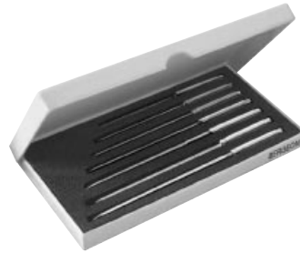
Nr. 30544-A Sortiment von 7 Reibahlen, mit geriffeltem Heft. Durchm. 0,69 - 3,53 mm.
