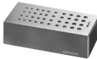
Nr. 5956 Korneisengesenk. 40 Kugeln, Durchm. 0,6 - 1,75 mm. Aus gehärtetem Stahl.
