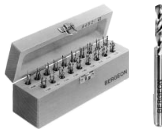
Nr. 6520-G Sortiment von 57 Spiralbohrern, Durchm. 0,50 - 2,30 mm. Schaft Ø 2,35 mm Aus Schnellstahl.
