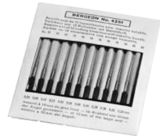
Nr. 4251 Sortiment von 12 Reibahlen mit Bakelitheft, Durchm. 0,33 - 0,69 mm.
