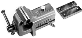
Nr. 2021 Abnehmbarer Schraubstock für Uhrmacher-Werktische. Backenbreite 45 mm.
